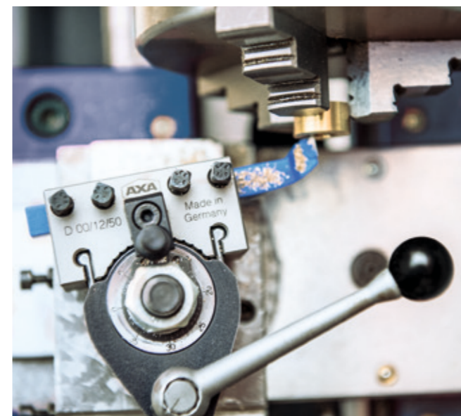
Drehstahlhalter D00/12/50 während der Bearbeitung
